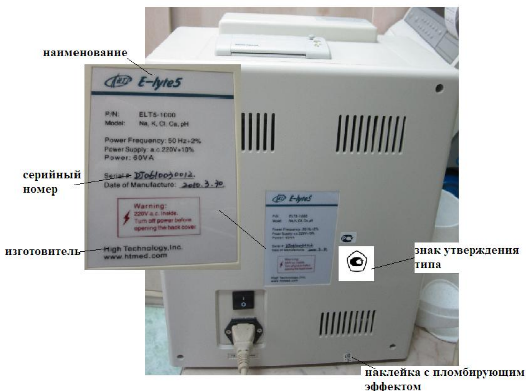
Рисунок 2 – Схема пломбирования и маркировки анализаторов
