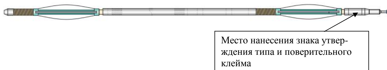
Рисунок 1- Общий вид скважинного инклинометра Кеерер и место нанесения поверительного клейма и знака утверждения типа.
