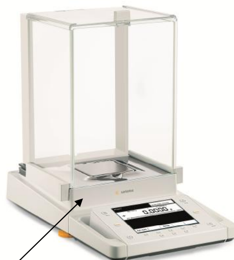
Рис. 3б – Весы со взвешивающим модулем 524S и модулем терминала MSU
