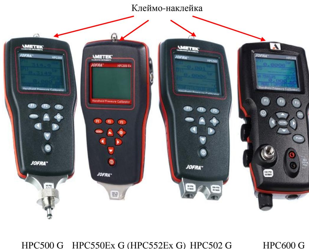
Рисунок 1 - Фотографии общего вида приборов и место нанесения поверительного клейма-наклейки
