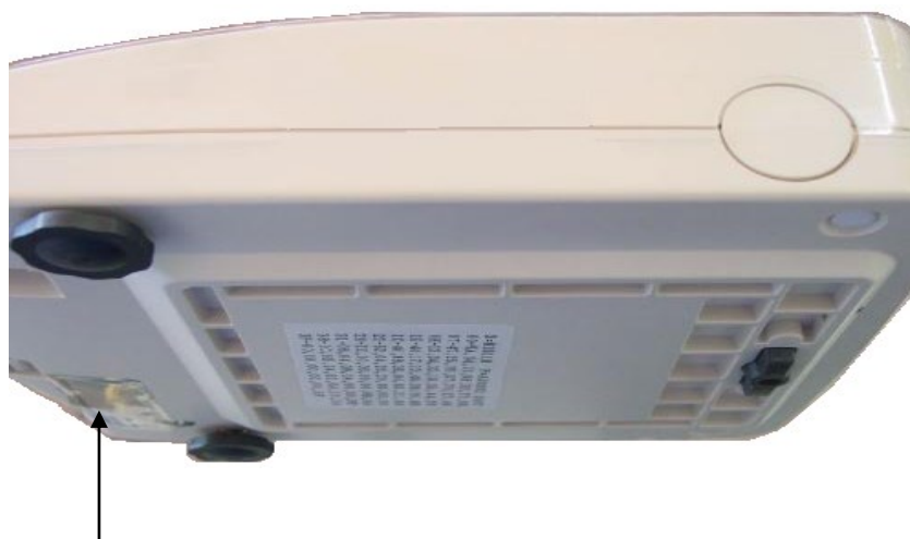
Место размещения пломбы (переключатель юстировки)
