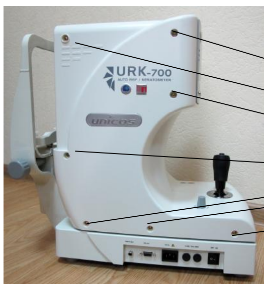
Рисунок 1 – Общий вид авторефрактокератометра URK-700, схема его маркировки и места пломбирования
