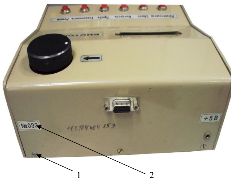
Рисунок 2 – Измеритель токсичности «Биотокс-Ч» - вид сзади, 1- место пломбирования, 2- место маркировки.
