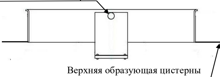
Рисунок 5 – Схема пломбировки от несанкционированного изменения положения указателя уровня налива в полости цистерны модификации БК, обозначение места нанесения знака поверки
