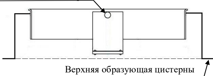
Рисунок 4 – Схема пломбировки от несанкционированного изменения положения указателя уровня налива в горловине цистерны модификации СК, обозначение места нанесения знака поверки
