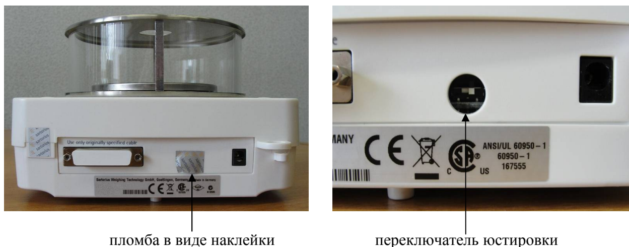
Рисунок 2 - Схема пломбировки от несанкционированного доступа
