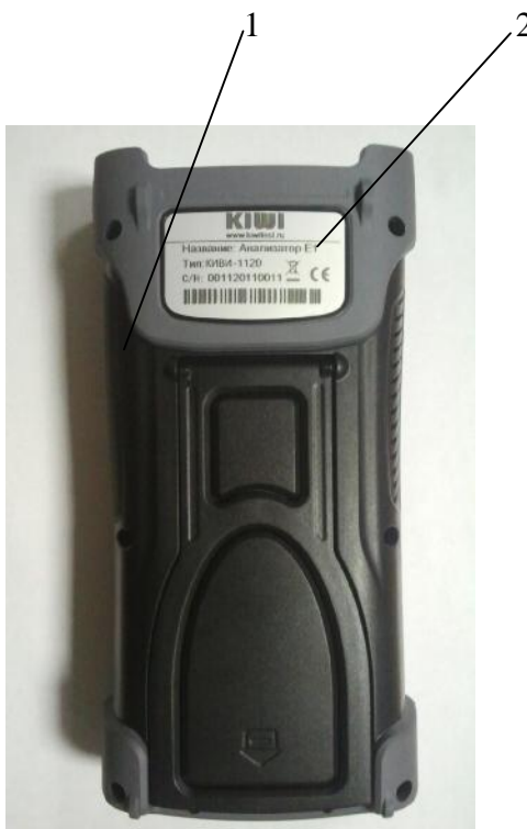
1 - место установки пломбы; 2 - место нанесения маркировки Рисунок 2
