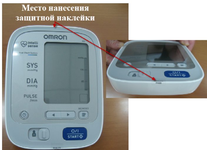
Рисунок 9 - Место нанесения защитной наклейки, исполнения: M6 (HEM-7213-ARU) M6 Comfort (HEM-7223-ARU) M5 (HEM-7214-ARU) M5 Comfort (HEM-7224-ARU)
