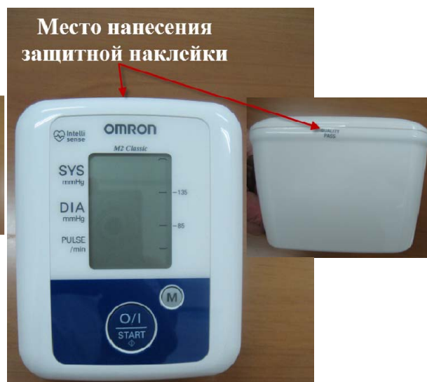
Рисунок 10 - Место нанесения защитной наклейки, исполнения: M2 Basic (HEM-7116H-RU) M2 Basic (HEM-7116H-ARU) M2 Classic (HEM-7117H-ARU) M2 Plus (HEM-7119-ARU) M3 Expert (HEM-7200H-ARU) M3 Family (HEM-7202-ARU)
