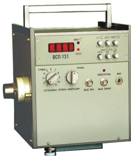
Рисунок 1 - Виброустановка поверочная переносная ВСП-131
