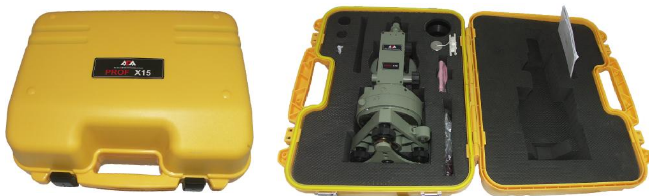
Рисунок 2 – Внешний вид футляра и схема размещения теодолита в футляре
