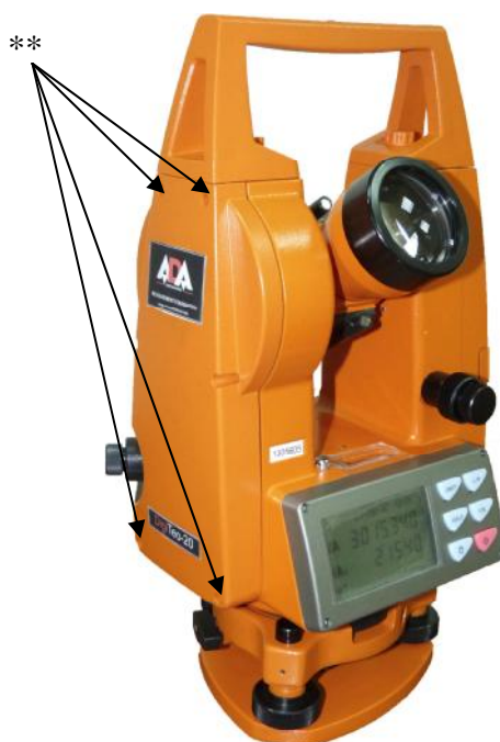
Примечание ** - места пломбирования от несанкционированного доступа Рисунок 3 - Схема пломбировки от несанкционированного доступа
