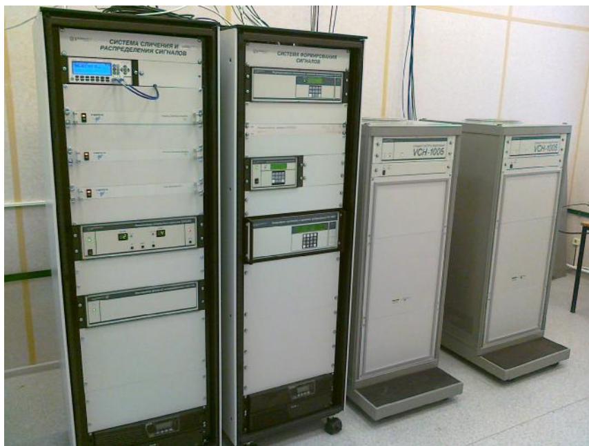
Рисунок 1 - Рабочий эталон единиц времени и частоты VCH-015 ЯКУР.411735.007
