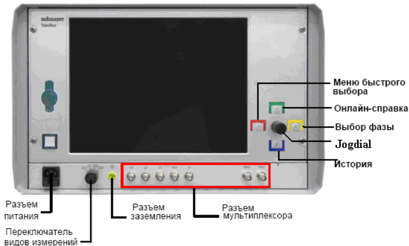
Рис 1 – Внешний вид прибора для обнаружения повреждений кабелей Teleflex VX
