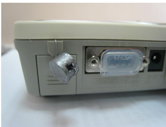
Рисунок 2 - Схема пломбировки от несанкционированного доступа
