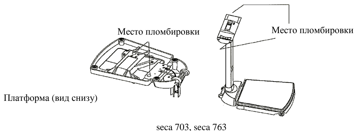
Рисунок 2 – Схема пломбировки от несанкционированного доступа весов seca 703, seca 763
