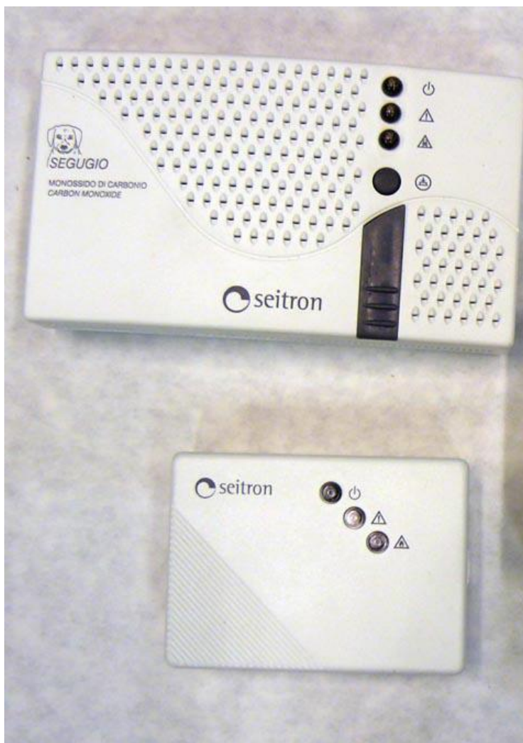
Рисунок 1 – Внешний вид сигнализатора RGD CO0 MP1 с внешним сенсором метана SGAMET
