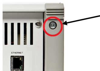
Рисунок 2 - Схема пломбировки от несанкционированного доступа
