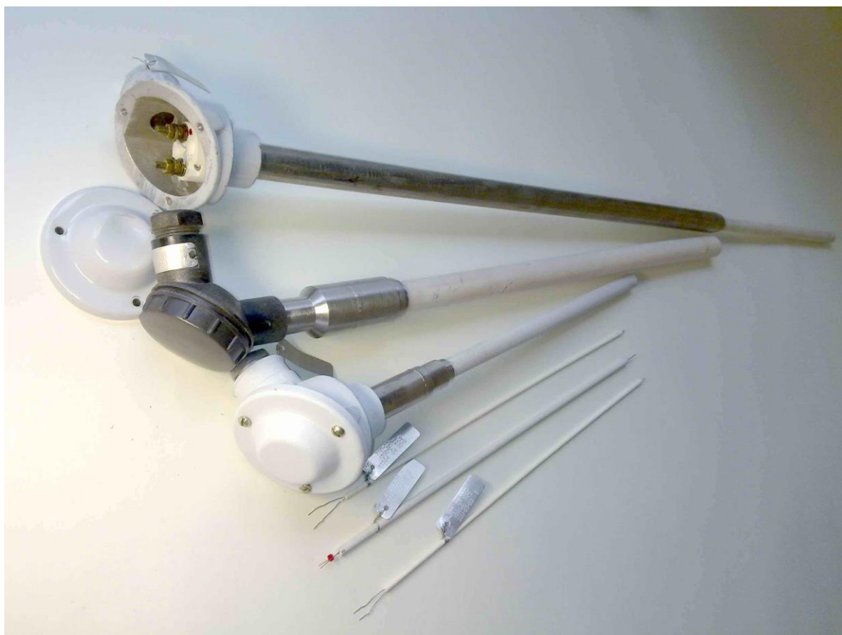
Рисунок 1 – ТП моделей ТПП-02, ТВР-03, ТПР-02, ТПП-01, ТПР-01, ТВР-01 (см. снизу вверх)
