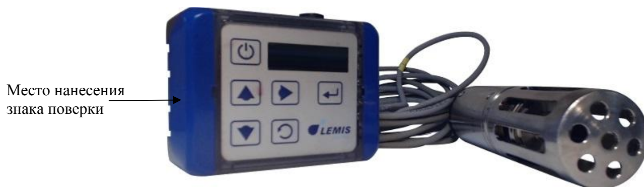
Рисунок 3 - Общий вид плотномеров DM-230.1A со светодиодным дисплеем и обозначение места нанесения знака поверки
