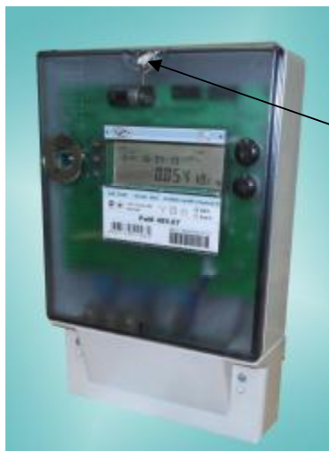
Рисунок 1 – Фотография общего вида и место установки пломбы поверителя счетчиков РиМ 489.07
