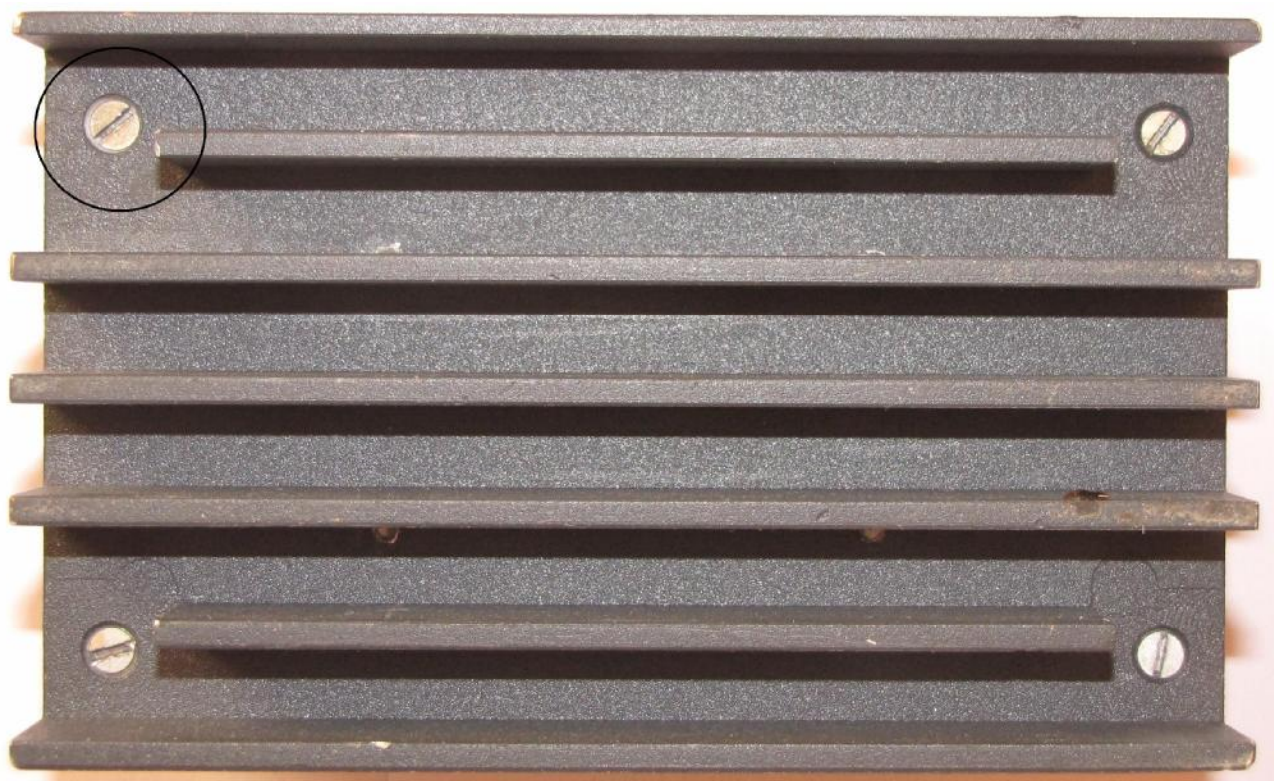
Рисунок 2. Мера сопротивления МС-10. Вид снизу. Кругом обозначено место клеймения.
