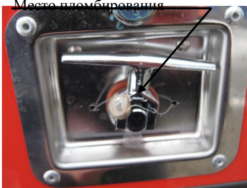
Рисунок 5 – Ручка открывания технологического отсека, или Заглушка открывания трубопровода слива топлива из ППЦ (в зависимости от конструктивного исполнения)
