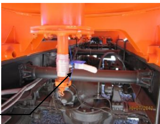
Рисунок 4 – Кран слива отстоя из АЦ
