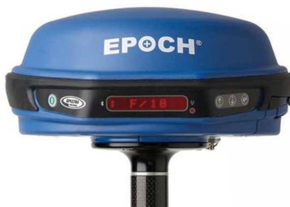
Внешний вид аппаратуры геодезической спутниковой Spectra Precision Epoch 50
