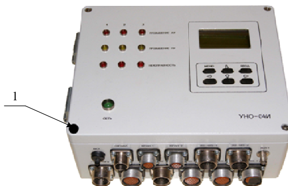
1 – Пломбы с оттиском клейма поверителя Рисунок 2 – Общий вид блока УНО-04И
