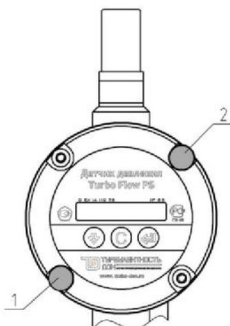
Рисунок 2 - Схема пломбирования датчика давления Turbo Flow PS.
