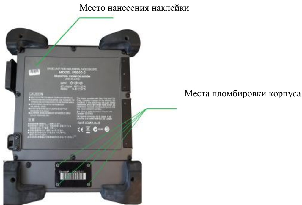
Рисунок 2 – Место пломбировки корпуса видеозэндоскопа и место нанесения наклейки
