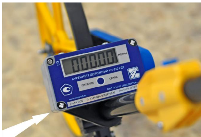
Рисунок 3 - Место установки пломб на электронный блок индикации курвиметра модели КИ-230 РДТ
