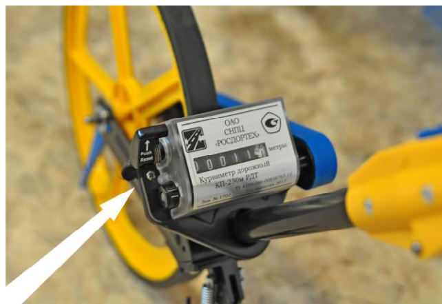
Рисунок 4 - Место установки пломбы на механический счетчик курвиметра модели КИ-230 РДТ
