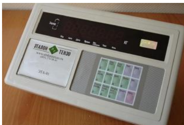
Рисунок 2 Внешний вид индикатора ЭТА-01
