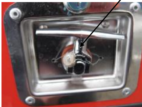
Рисунок 6 – Ручка открывания технологического отсека, или Заглушка открывания трубопровода слива топлива из ППЦ (в зависимости от конструктивного исполнения)
