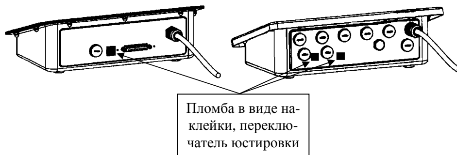
Рисунок 2 - Схема пломбировки от несанкционированного доступа.
