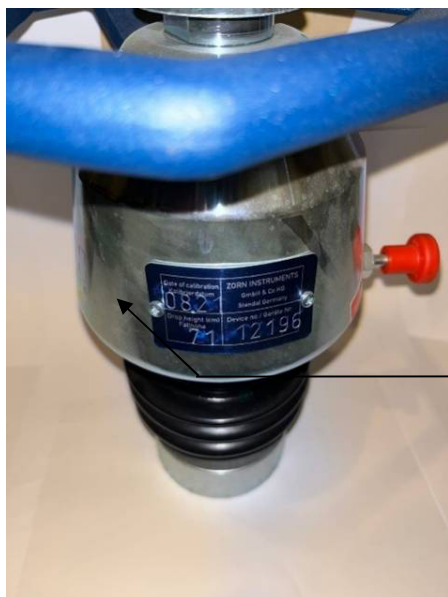
Рисунок 8 - Место нанесения знака утверждения типа
