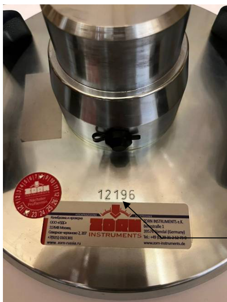
Рисунок 6 - Место нанесения заводского номера на нагрузочной плите
