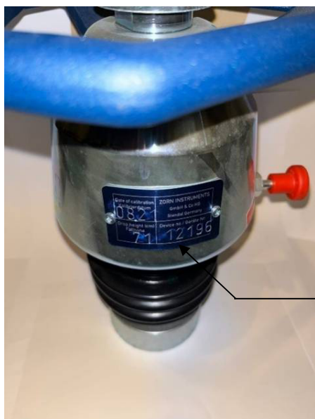
Рисунок 7 - Место нанесения заводского номера на нагрузочном приспособлении
