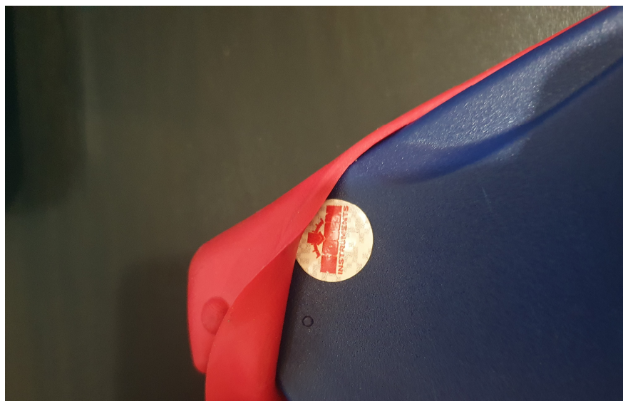
Рисунок 4 - Место защиты измерителей динамического модуля упругости грунтов Zorn ZFG от несанкционированного доступа
