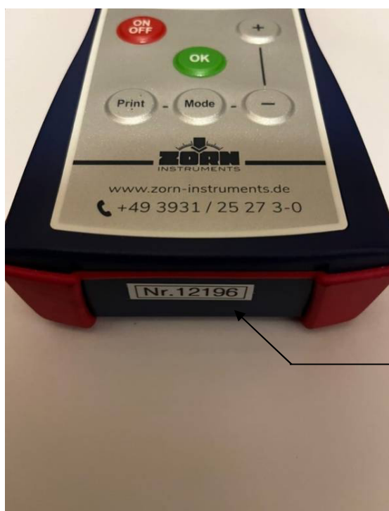
Рисунок 5 - Место нанесения заводского номера на электронном блоке
