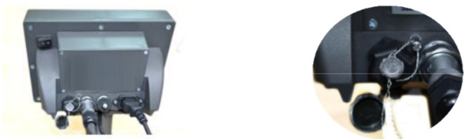
Рисунок 13 – Терминал ТИТАН 3Ц. Места пломбировки
