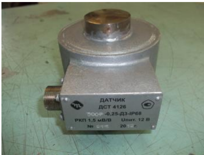
Рис. 1. Общий вид датчиков силоизмерительных тензорезисторных 4126 ДСТ
