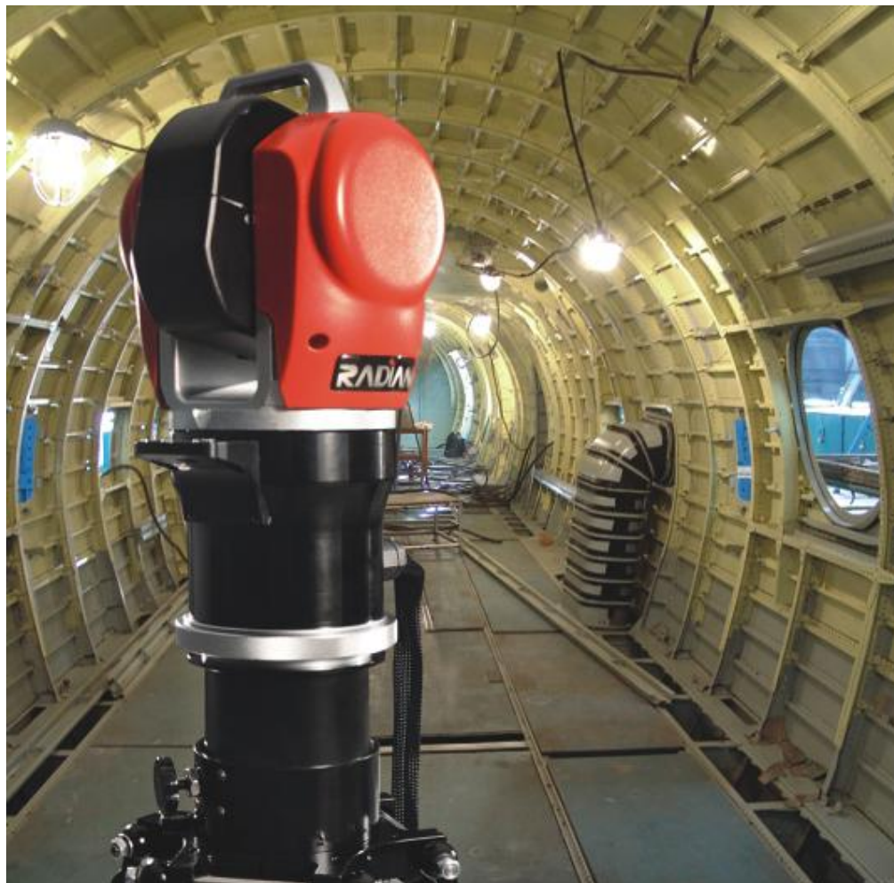
Рисунок 2 - Система лазерная координатно-измерительная API RADIANT в измерительном пространстве
