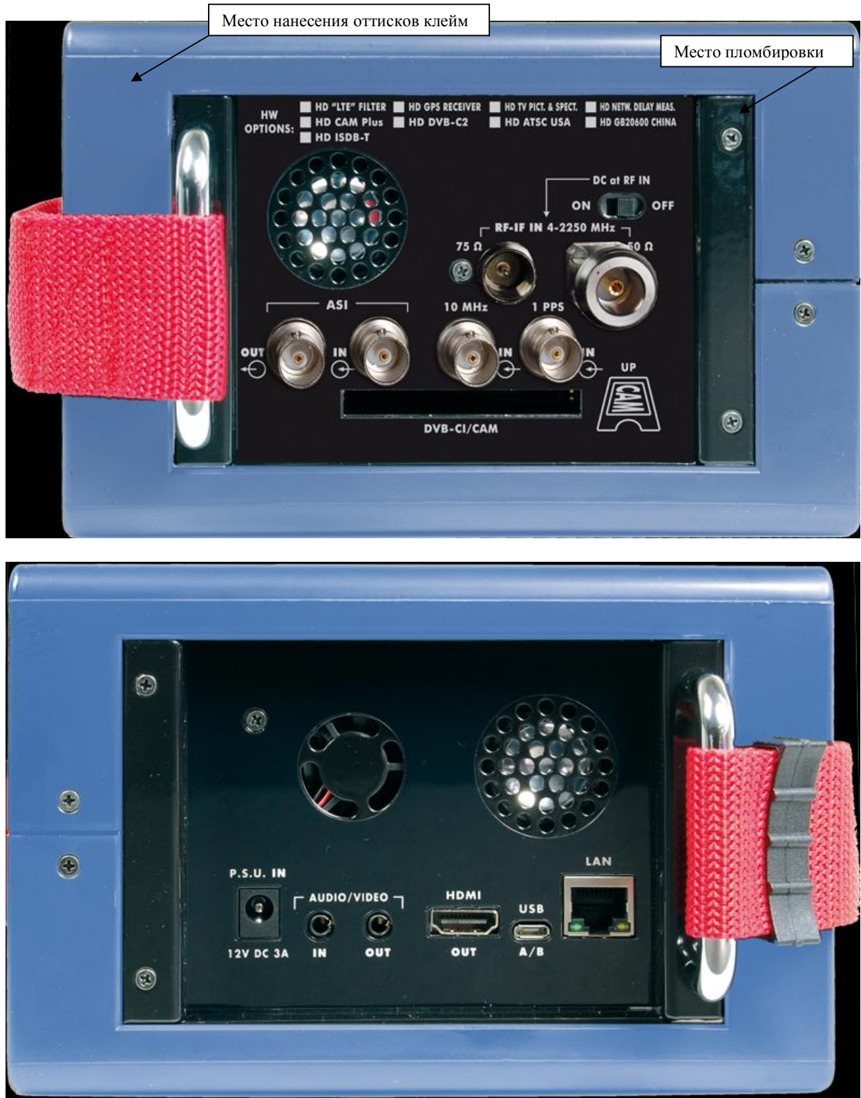
Рисунок 2 Схема пломбировки от несанкционированного доступа и нанесения отсисков клейм
