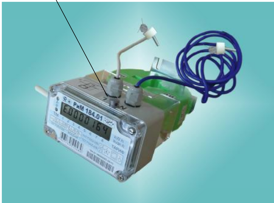
Рисунок 1 – Фотография общего вида и место установки пломбы поверителя ИПУЭ РИМ 184.01
