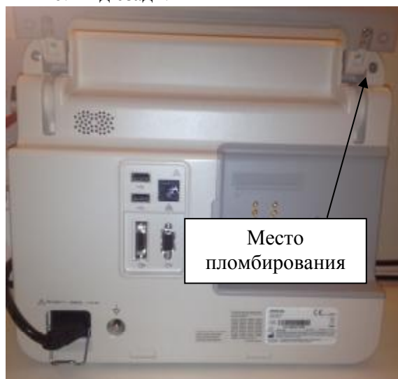
Рисунок 6. Монитор пациента модели iPM12. Вид сзади.
