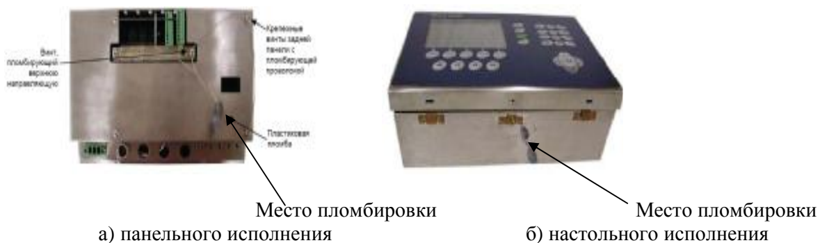
Рисунок 3 - Место пломбировки терминалов панельного и настольного исполнений
