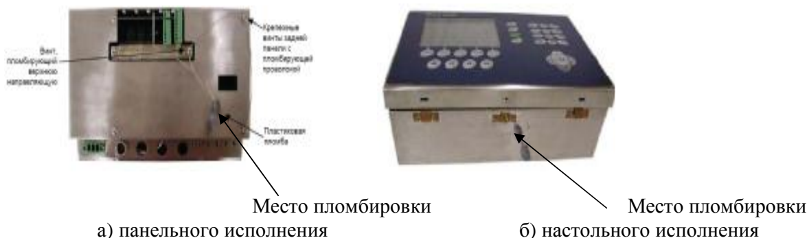
Рисунок 3 - Место пломбировки терминалов панельного и настольного исполнений
