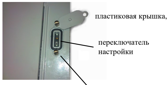
винты с отверстиями для установки пломбы
