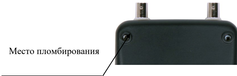
Рисунок 1 - Место нанесения пломбировки от несанкционированного доступа на панели электронного блока приборов модификаций ПУЛЬСАР-2.1, ПУЛЬСАР-2.2
