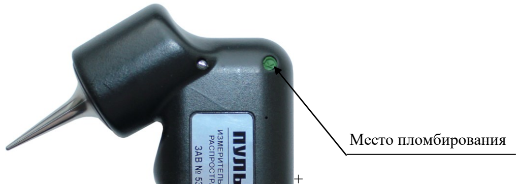
Рисунок 1 - Место нанесения пломбировки от несанкционированного доступа на панели электронного блока приборов модификаций ПУЛЬСАР-2.1, ПУЛЬСАР-2.2
