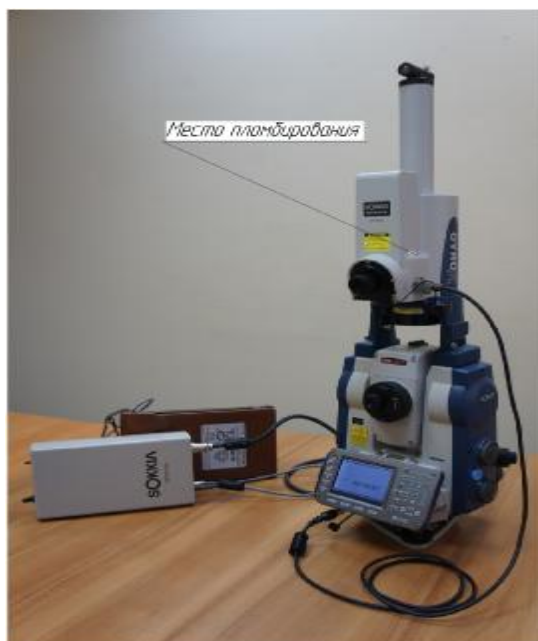
Рисунок 1. Общий вид гиростанции автоматической GYRO X.
