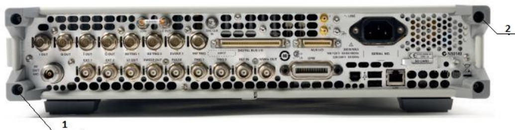
Рисунок 2 – Схема пломбировки генераторов от несанкционированного доступа, где 1; 2 – места для нанесения оттисков клейм.
