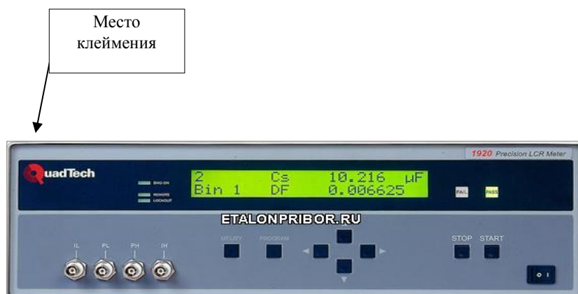
Рисунок 1 Измеритель параметров иммитанса QuadTech 1920
