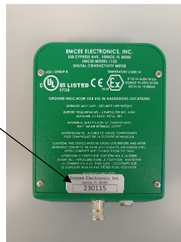
Рисунок 1б – Общий вид задней поверхности вторичного преобразователя измерителя удельной электропроводимости углеводородных жидкостей EMCEE 1152 с указанием места нанесения и формата заводского номера
