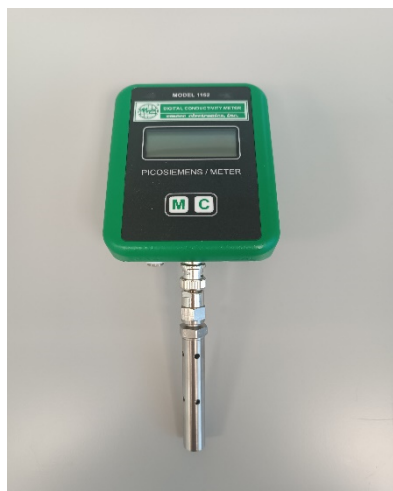
Рисунок 1а – Общий вид измерителя удельной электропроводимости углеводородных жидкостей EMCEE 1152
