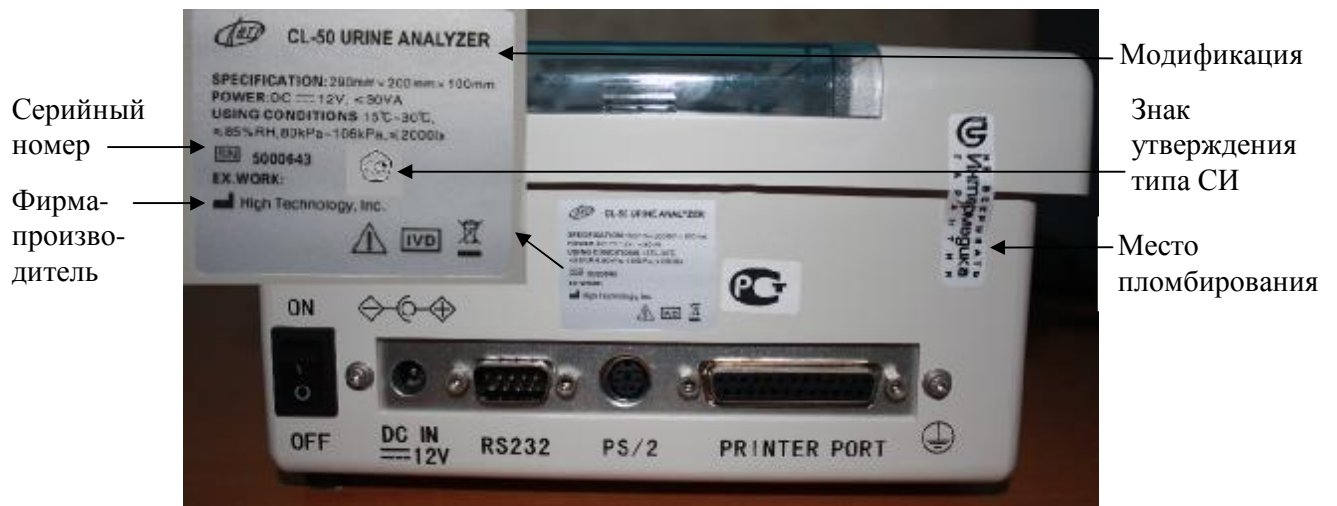
Рисунок 3 – Схема маркировки и пломбировки анализаторов CL-50
