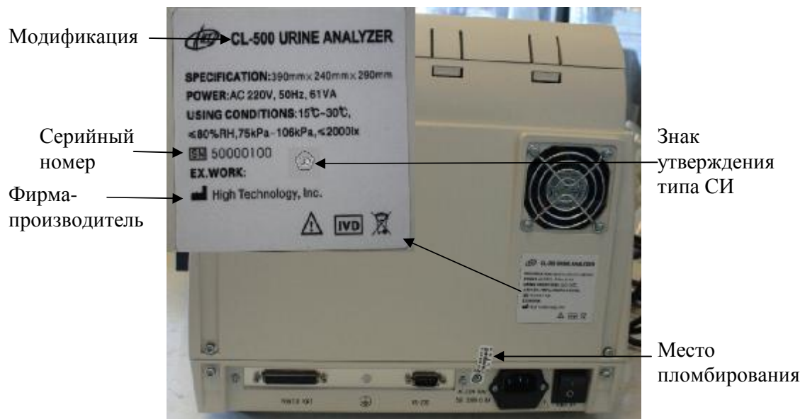
Рисунок 4 – Схема маркировки и пломбировки анализаторов CL-500
